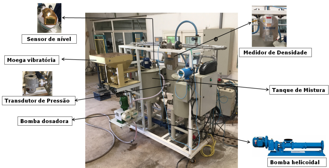
Figura 12. Foto da unidade de preparo de fluidos de perfuração.
