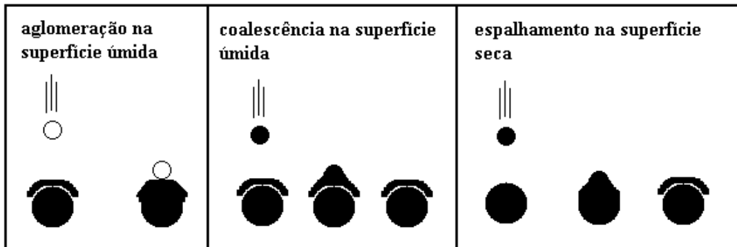
Figura 2.5 - Mecanismo estabelecido para o crescimento da partícula (LINK & SCHLUNDER, 1997)
