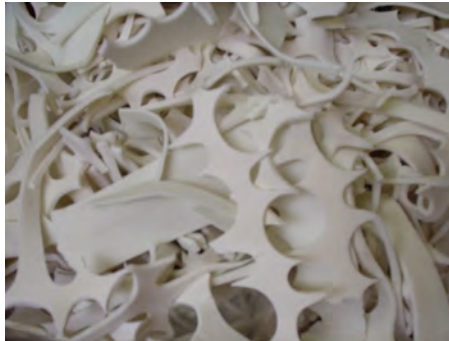
Figura 7 - Resíduo da industria calçadista proveniente do corte de chapas de SBR expandido
