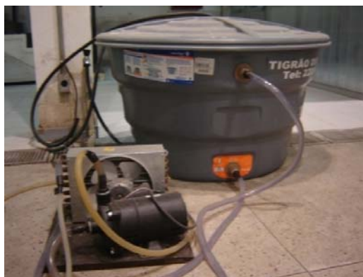
Figura 9. Sistema de refrigeração do óleo térmico com reuso de água da torneira
