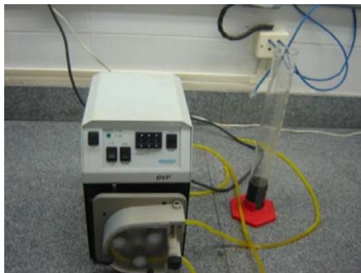
Figura 11. Sistema de alimentação da carga calibrada manualmente
