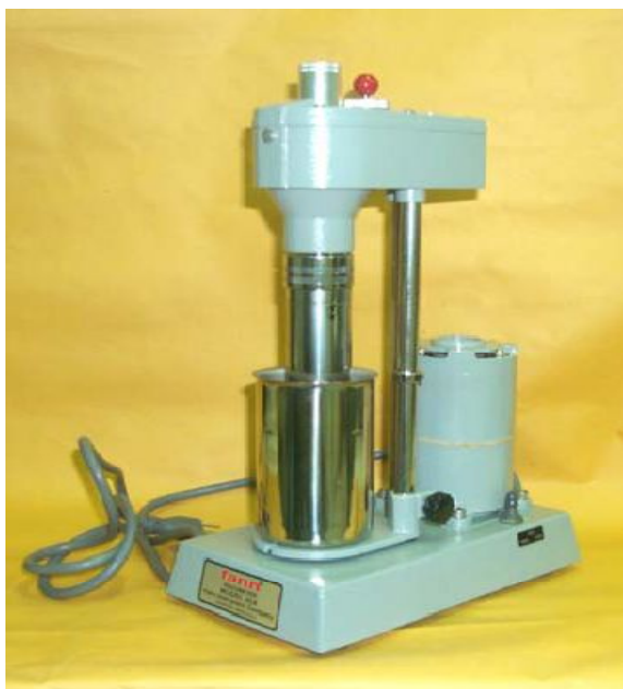
Figura 2.3 – Viscosímetro FANN V. G. Metter modelo 35 A.
