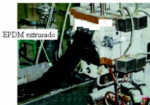
Figura 3. Processo de extrusão: EPDM saindo do orifício da extrusora (FUKUMORI & MASUSHITA, 2002).
