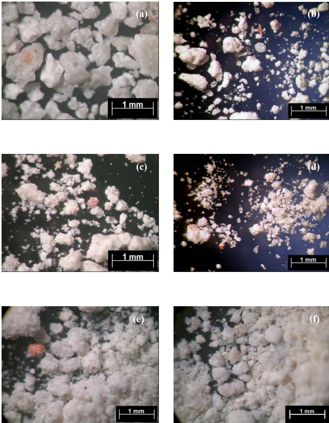
Figura 40. Micrografias ópticas das amostras de \text{AlPO}_4\text{-Fe/PE-g-MA} : (a) 20 X, (b) 50 X, (c) 70 X, (d) 90 X, (e) 95 X e (f) 97 X.
