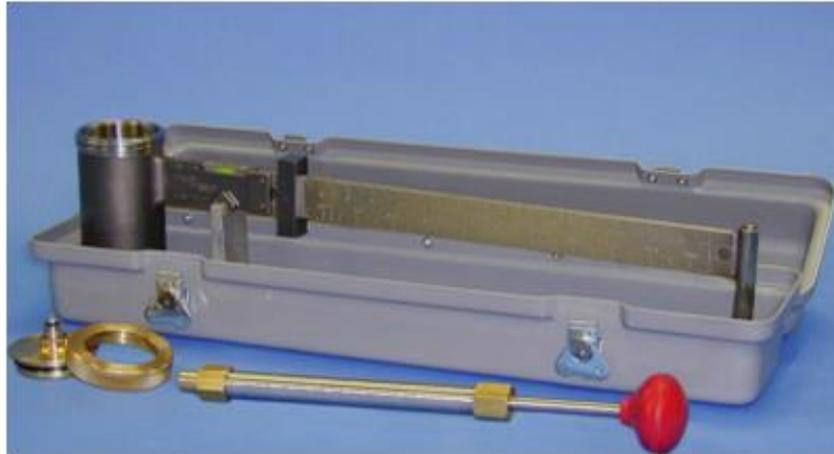
**Figura 14.** Balança de lama.
