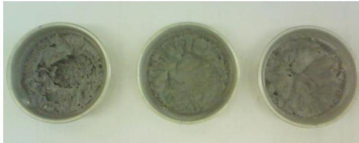
**Figura 18.** Formas de alumínio com fluido de perfuração base água depois de seco (Triplicata).
