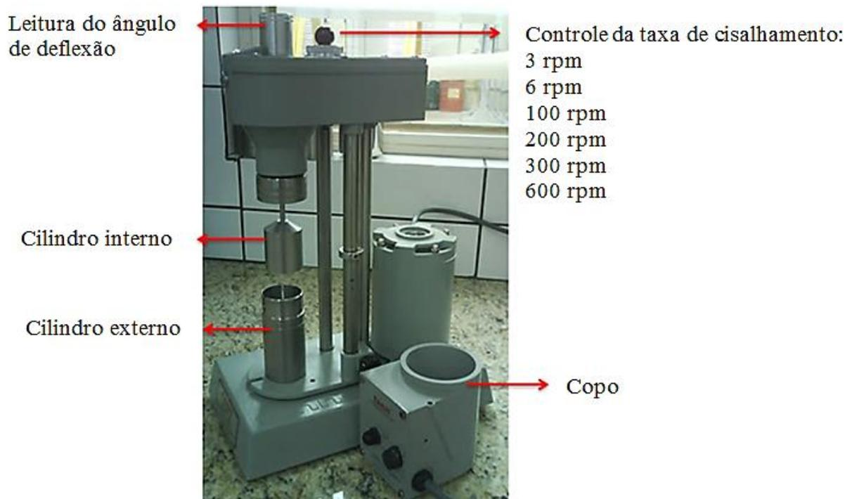
**Figura 16.** Viscosímetro FANN 35A em detalhes.
