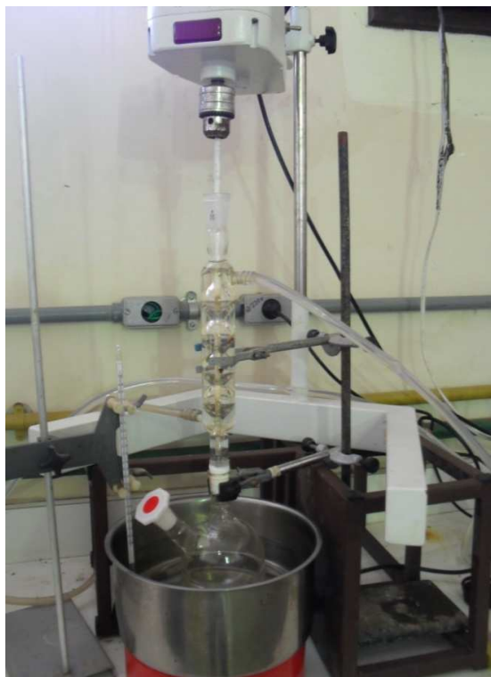
Figura 21 - Aparato experimental utilizado para reação de transesterificação alcalina convencional
