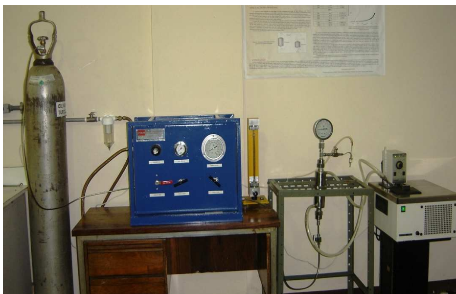
Figura 23 - Aparato experimental utilizado na reação de transesterificação alcalina com fluido supercrítico
