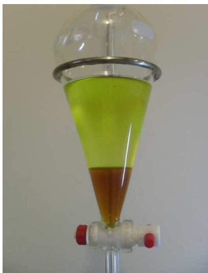
Figura 24 - Separação de fases entre biodiesel e glicerol
