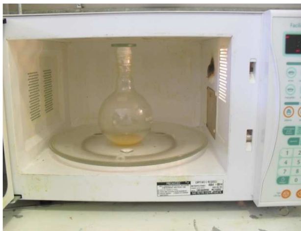
Figura 22 - Reação de transesterificação com utilização de forno de microondas
