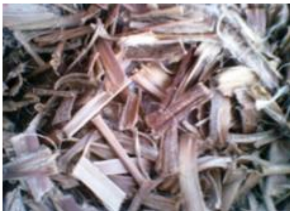
Figura 14: Fibras in natura , após 24 horas em estufa a 70°C.
