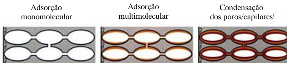
Figura 1: Fenômenos durante o processo de adsorção (adaptado de FREITAS et al. , 2008).
