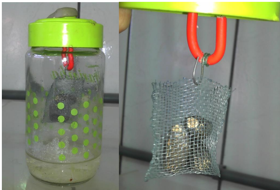
Figura 13 – Aparato experimental utilizado no acondicionamento de grãos de pinhão-manso para a determinação do teor de umidade de equilíbrio higroscópico.
