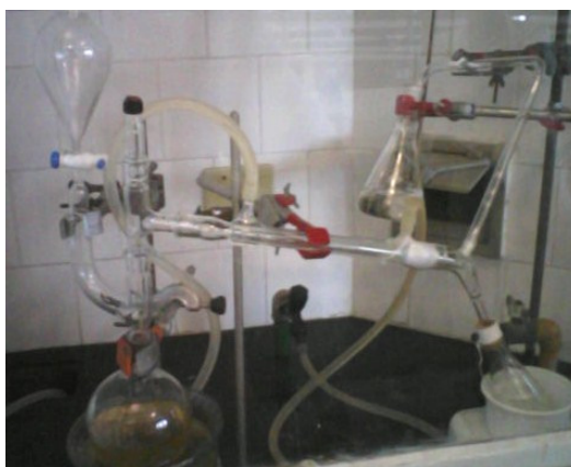
Figura 10. Montagem do sistema de destilação para síntese de diazometano
