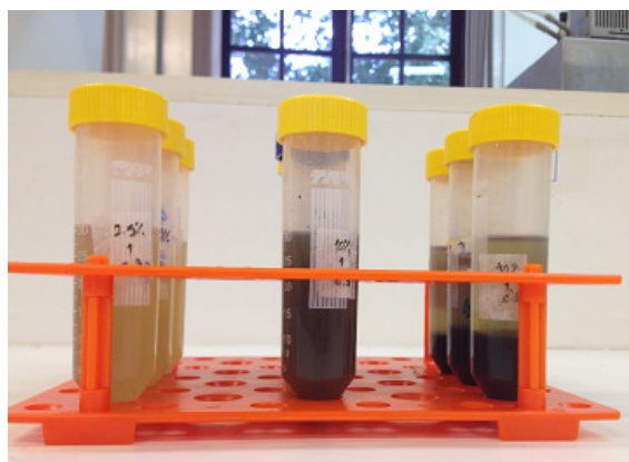
Figura 18 – Tubos Falcon contendo misturas poliméricas nas concentrações de 2,5%, 10% e 40% de massa de espirulina para avaliação da estabilidade dimensional através da separação de fases.
