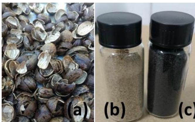
Figura 12: Ilustração da matéria-prima utilizada. a) casca da semente da seringueira *in natura*; b) casca da semente da seringueira moída; c) casca da semente da seringueira após o processo de calcinação.
