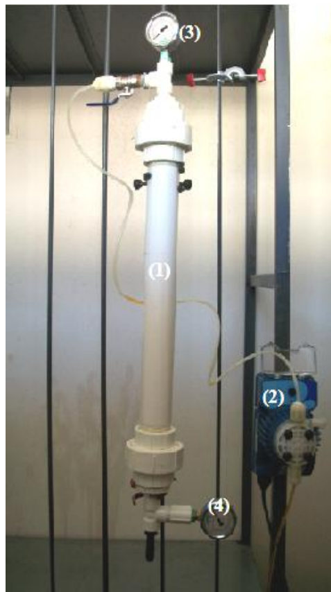
Figura 13 - Aparato experimental dos ensaios em modo contínuo: coluna de leito fixo. Leito da coluna (1); bomba dosadora (2); manômetros (3) e (4).
