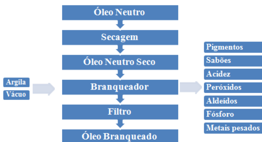
Figura 1 - Esquema do processo contínuo do branqueamento de óleo de soja. Fonte: Adaptada de Mandarinino & Roessing (2001).
