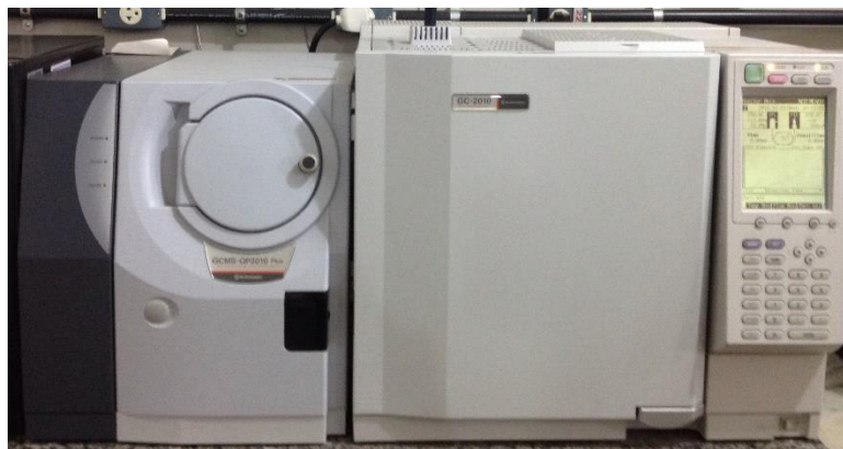
Figura 10 – Cromatógrafo a gás GC-2010 SHIMADZU utilizado nos experimentos
