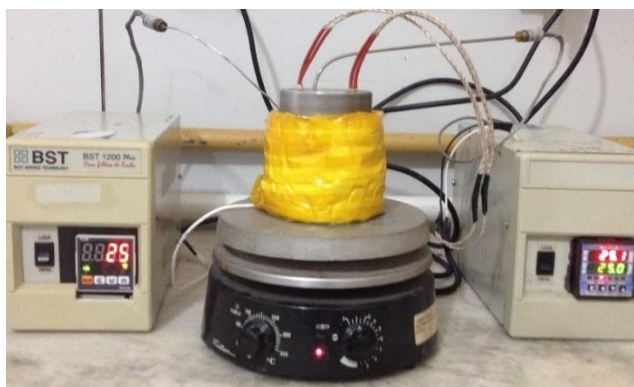
Figura 17 – Unidade experimental utilizada para determinação do coeficiente de atividade na diluição infinita por SPME
