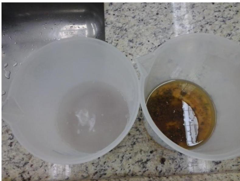
**Figura 42-** preparação dos fluidos base água e base óleo.
