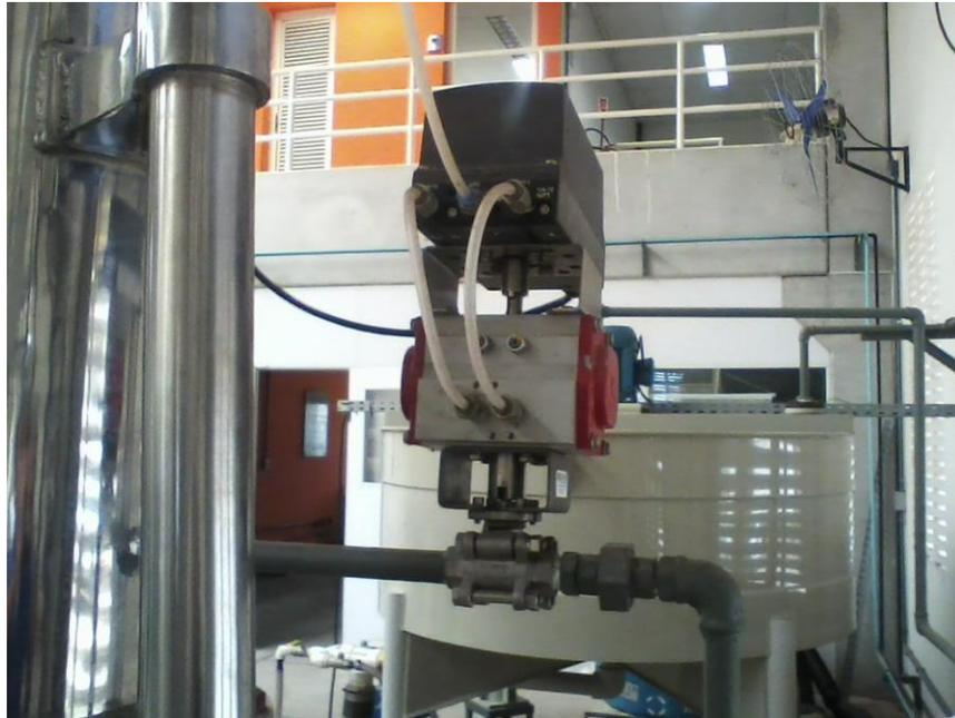
**Figura 3.8** - Válvula de permeabilidade com esfera caracterizada.
