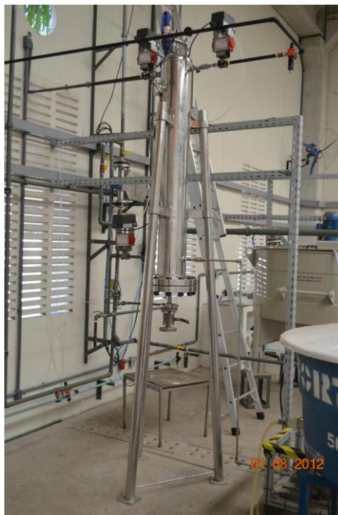
**Figura 3.5** - Tanque de pressão.
