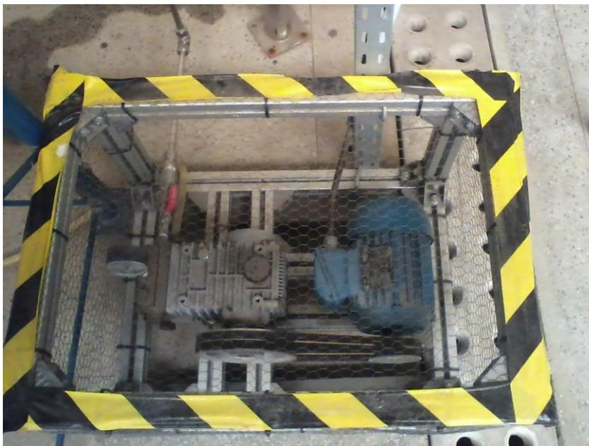
**Figura 3.10** - Bomba de reposição de água para tanque de pressão.
