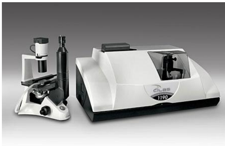
Figura 9: Analisador de tamanho de partícula Cilas 1190 acoplado ao microscópio (Fonte: www.cilas.com ).
