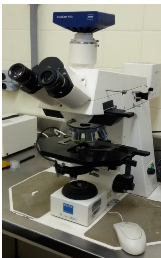
Figura 11: Microscópio ótico (Zeiss) equipado com a câmera AxioCam MRc.
