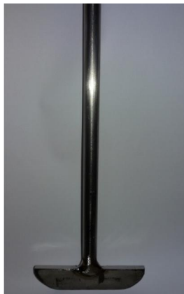
Figura 14: Haste (homemade) em aço inoxidável com extremidade na forma de pá.
