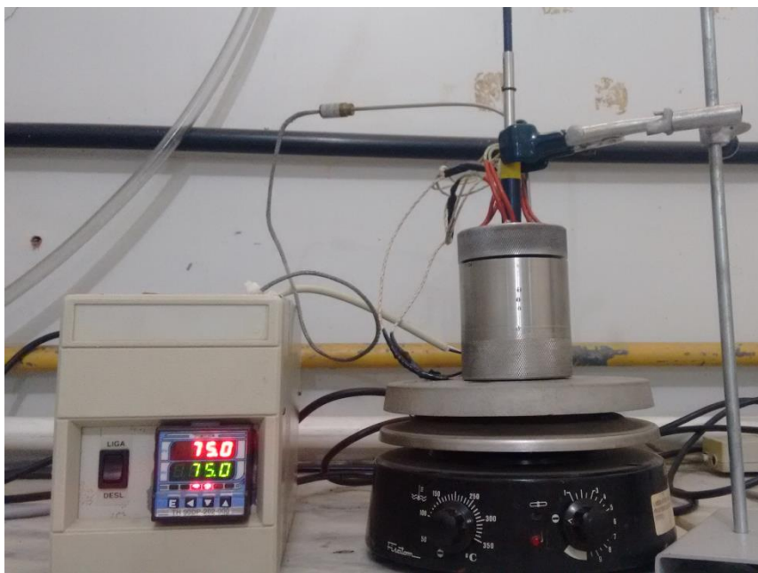
Figura 9 - Extração por SPME utilizando a unidade experimental.
