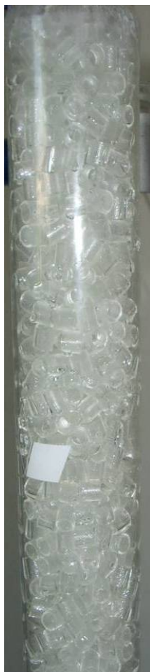
Figura 6 – Seção recheada da unidade experimental
