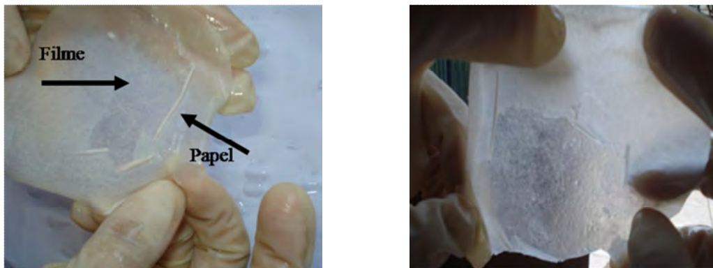
Figura 18 - Membranas após imersão em água destilada para retirada do suporte de papel.
