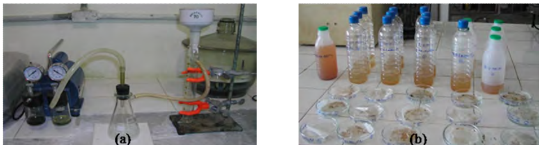
Figura 23 - (a) - Sistema utilizado para filtração; (b) - Membranas após o processo de filtração.
