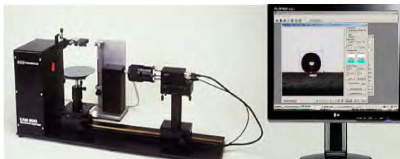
Figura 22 - Conjunto Software e equipamento de medida de ângulo de contato KSV modelo CAM 101.
