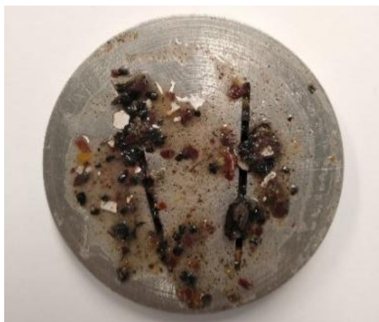
Figura 64. Slot contendo LCM granular após o teste de selamento de fenda. Condições: 20 lb/bbl, 500 psi e 50°C.
