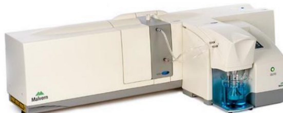
Figura 29. Analisador de partículas por espalhamento de luz Malvern Mastersizer 2000.
