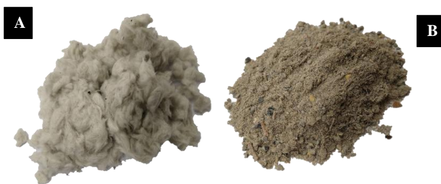
Figura 27. Materiais de combate à perda escolhidos. (A) LCM fibroso e (B) LCM granular.
