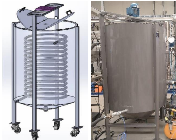
Figura 45. Tanque trocador de calor.
