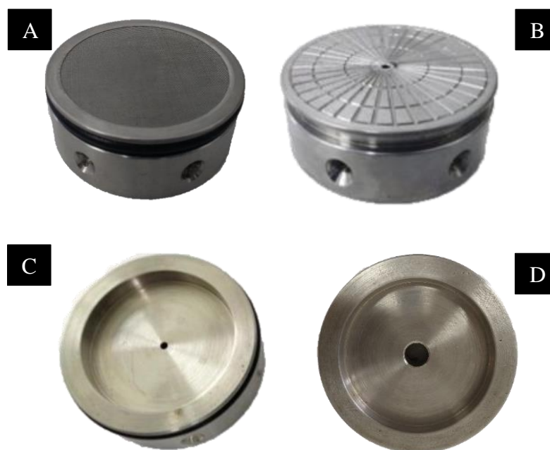
Figura 33. (A) Base original de filtração; (B) base original para teste de selamento em fendas; (C) Base modificada por Magalhães et al. (2019); (D) Base modificada.
