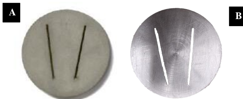
Figura 34. Discos ranhurados utilizados na célula de filtração HTHP. (A) Disco de rocha porosa e (B) disco de aço INOX.
