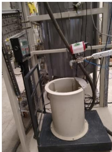
Figura 49. Balança e tanque de volume perdido pela fratura.
