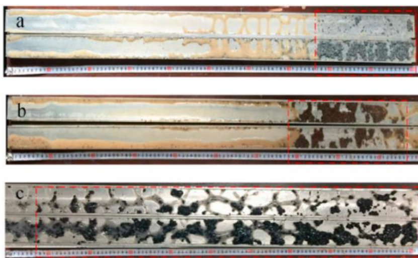
Figura 25. Zona de selamento dentro da fratura de 2 mm. (A) 10% de SCC, (B) 10% de NS e (C) 10 % de RUB.
