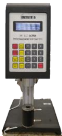
Figura 30. Viscosímetro utilizado no estudo do comportamento reológico dos fluidos.
