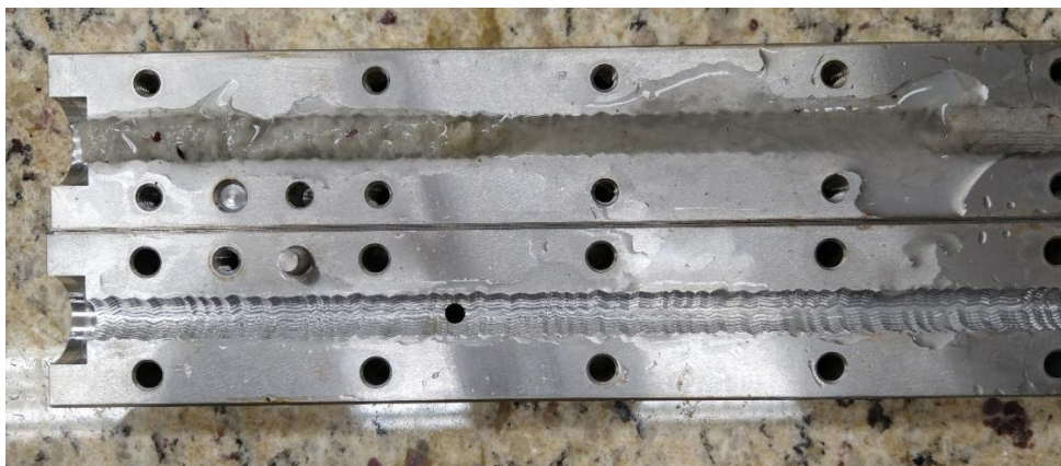
Figura 97. Fratura de 5 mm do SEF 2.0 após o teste de selamento do LCM fibroso.
