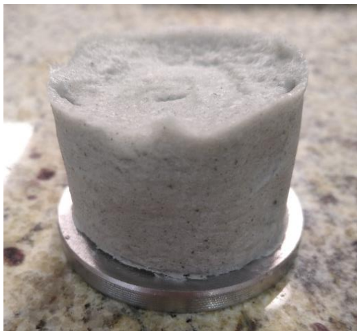
Figura 70. Slot contendo LCM fibroso após o teste de selamento de fenda. Condições: 20 lb/bbl, 500 psi e 50°C.
