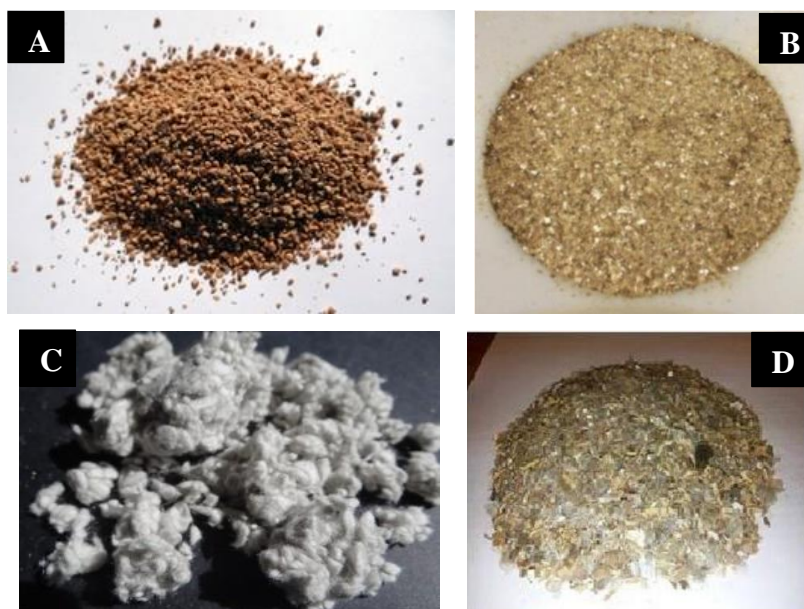
Figura 10. Tipos de LCMs convencionais. (A) Granular, (B) Flocos, (C) Fibrosos e (D) Mistura de LCM's.
