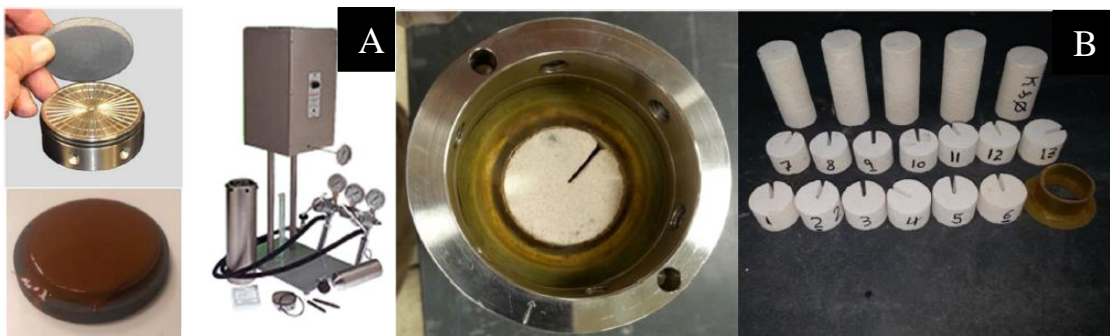
Figura 19. (A) Célula de filtração HTHP; (B) slot de fratura.
