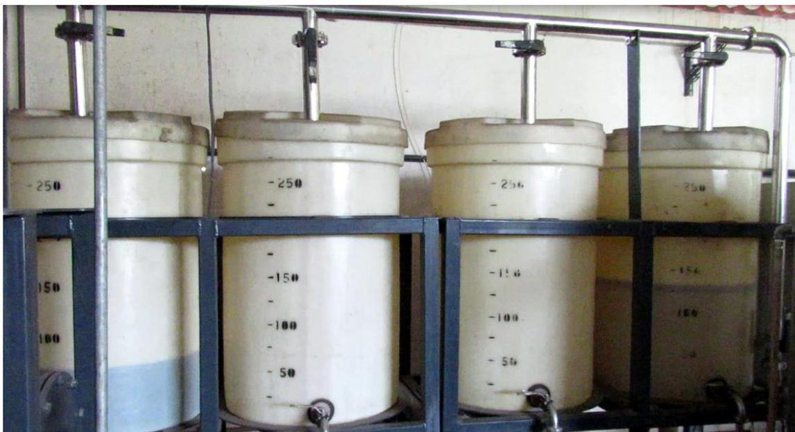
Após o tempo necessário para separação por diferença de densidade, o glicerol é recolhido para posterior análise, e o biodiesel bruto é direcionado para a coluna de adsorção. A Figura 38 ilustra o recolhimento do biodiesel após a etapa de purificação.
