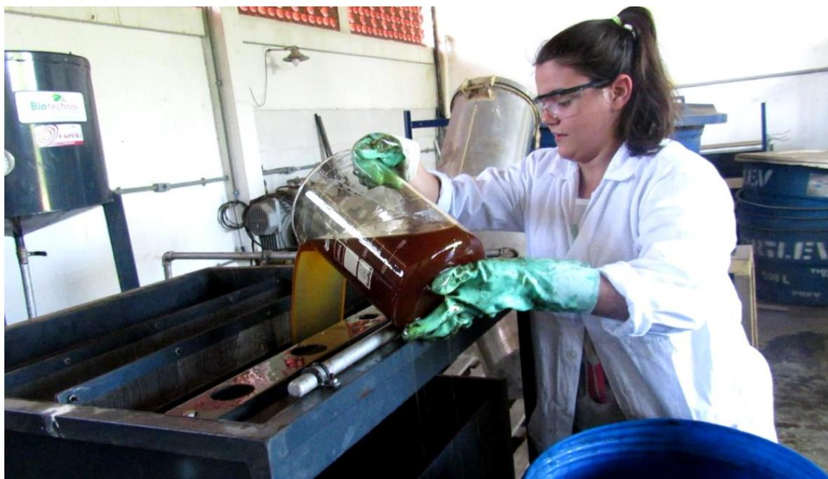
Paralelamente, o metanol é adicionado ao misturador com auxílio de uma bomba, e o catalisador é adicionado manualmente. A Figura 35 e 36 ilustram a adição do metanol e do catalisador, respectivamente.
