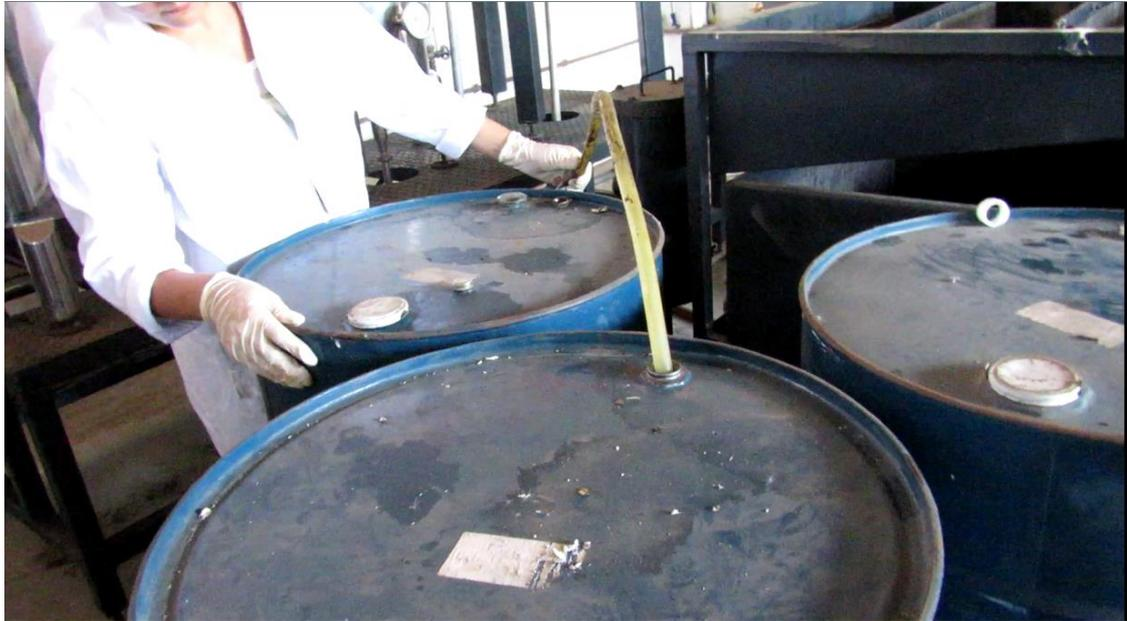
**Figura 36:** Inserção manual do catalisador no tanque misturador
