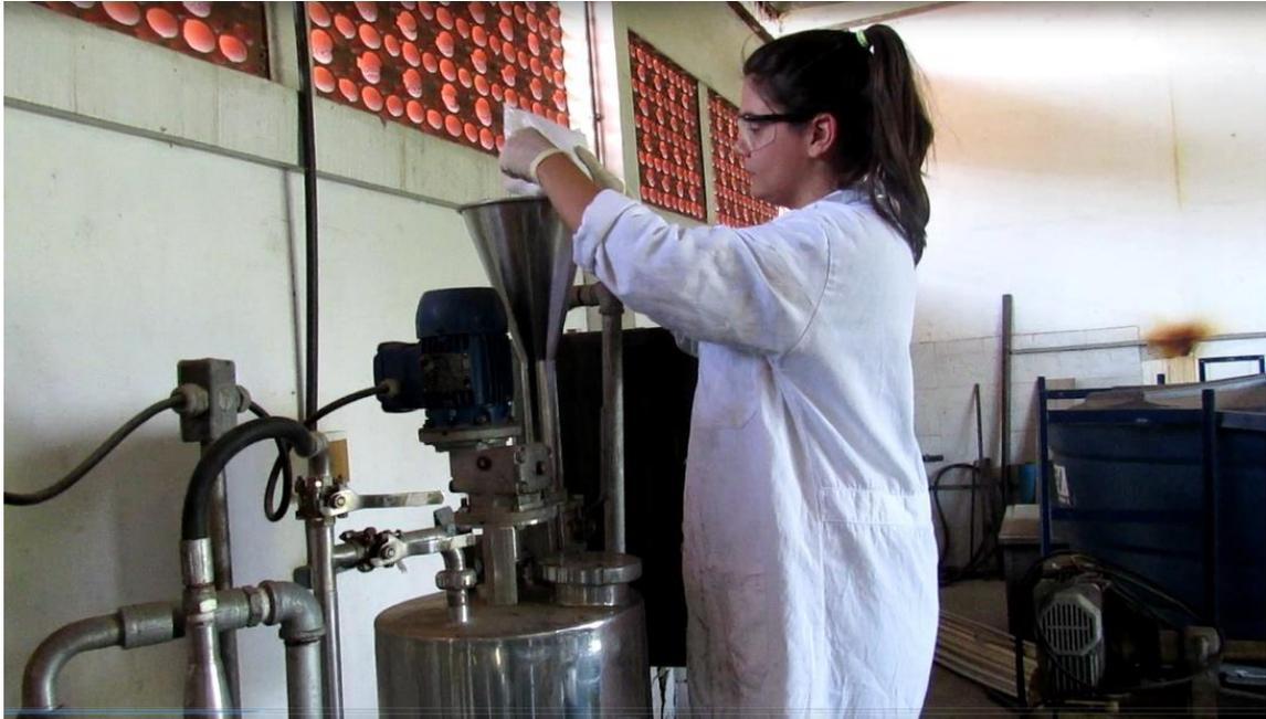
Após a homogeneização da mistura de metanol e catalisador e o aquecimento do óleo, ambas as correntes são direcionadas para o reator de transesterificação.
