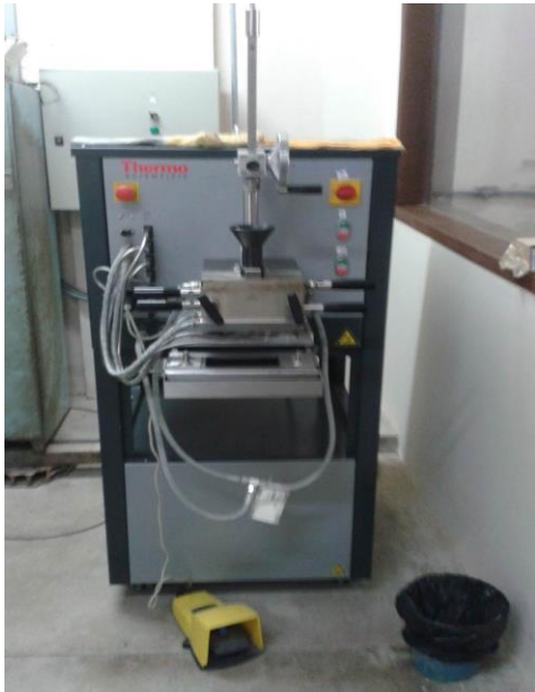
Figura 23. Reômetro de torque Thermo Scientific, modelo PolyLab QC, com rotor modelo roller
