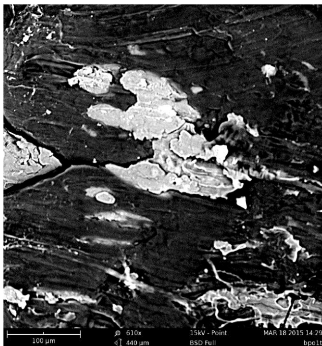
Figura 46. Micrografia de SEM da Amostra 1 (PEBD/TPS/Q – 0,0% Q) antes do ensaio de biodegradação
