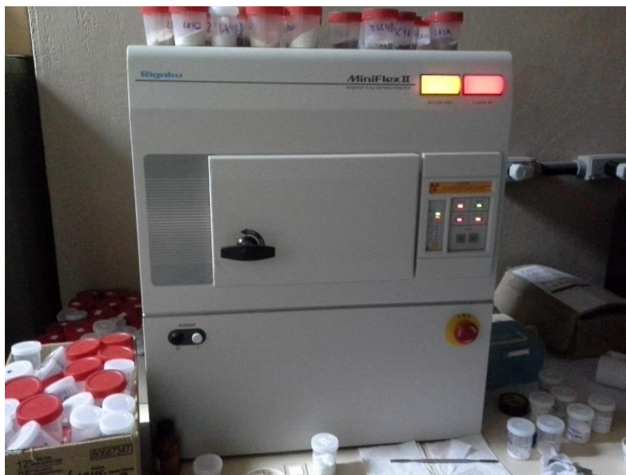
Figura 33. Foto do Difrator de Raio X, marca Rigaku, modelo Mini Flex II,
