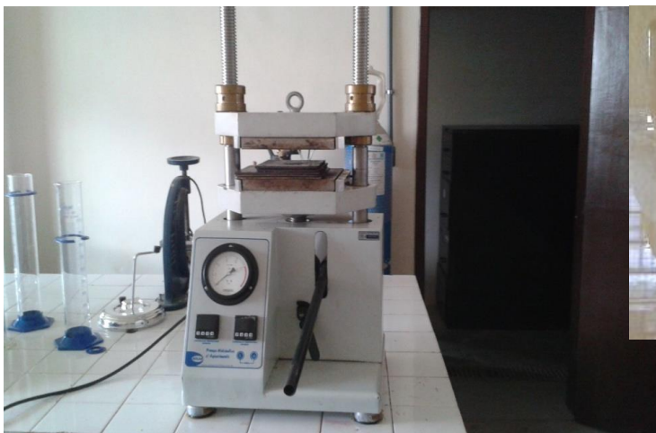
Figura 25. Prensa hidráulica com aquecimento, marca SOLAB, modelo SL-11
