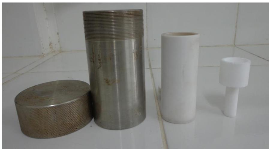
**Figura 3.3:** Autoclave especial de Teflon e aço usada para a síntese em meio seco.
