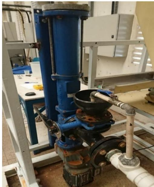
Figura 20 – Bomba posicionada na saída do sistema de adição de sólidos.
