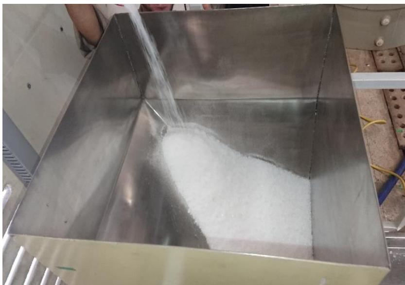
Figura 28 – Abastecimento de NaCl ao sistema de adição de sólidos.
