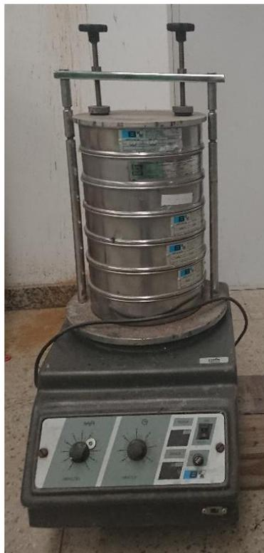
Figura 26 – Conjunto de peneiras e sistema vibratório.
