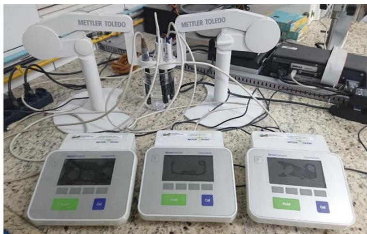
Figura 32 – Condutivímetros Metler Toledo SevenCompact S230.
