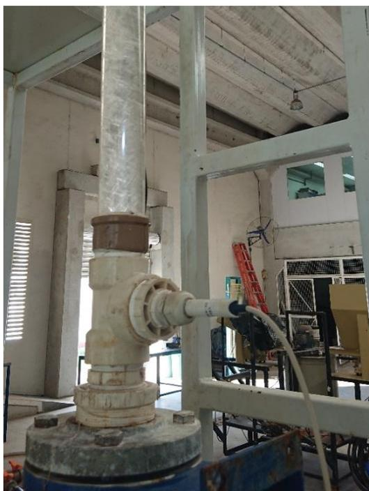
Figura 33 – Eletrodo posicionado na unidade experimental.
