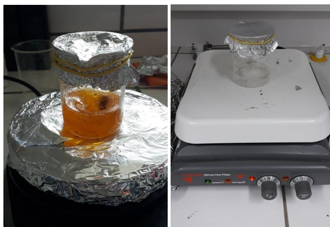
Figura 14: Diluição das cascas de cenoura e PLA em diclorometano, sob agitação magnética.
