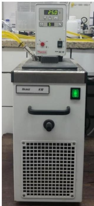
Figura 28. Banho termostático HAAKE K10 utilizado para controle da temperatura nos experimentos reológicos.
