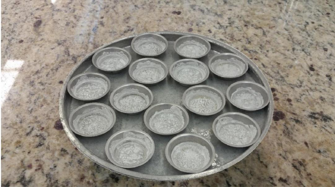
Figura 32. Cristais de cloreto de sódio formados após técnica gravimétrica.
