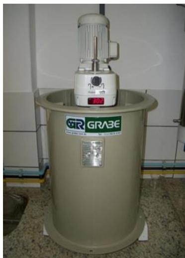
Figura 24. Foto da unidade experimental utilizada na preparação dos fluidos e nos experimentos de cinética.
