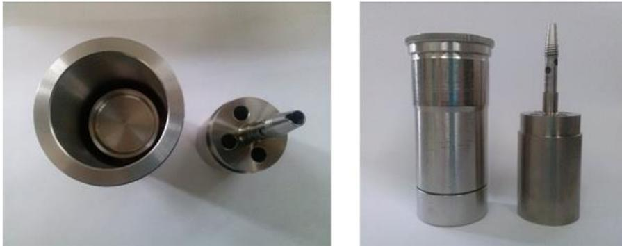
Figura 27. Geometria de cilindros coaxiais utilizada nos experimentos reológicos. À esquerda sua vista superior e à direita sua vista frontal.
