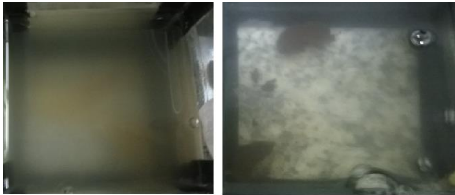
Figura 96. Aspecto inicial da água nutriente contendo TPS/Q (100/15%) e TPS/FC (100/15%), respectivamente, do dia 07/10
