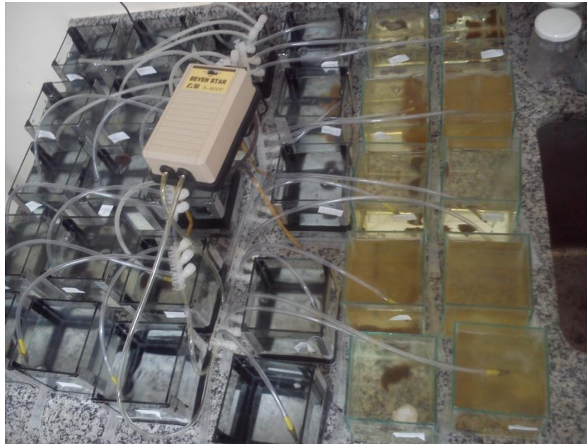
Figura 20. Sistema experimental contendo os diferentes meios hídricos e as amostras dos filmes poliméricos durante o ensaio de biodegradação
