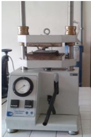
Figura 15. Prensa hidráulica com aquecimento, marca SOLAB, modelo SL-11
