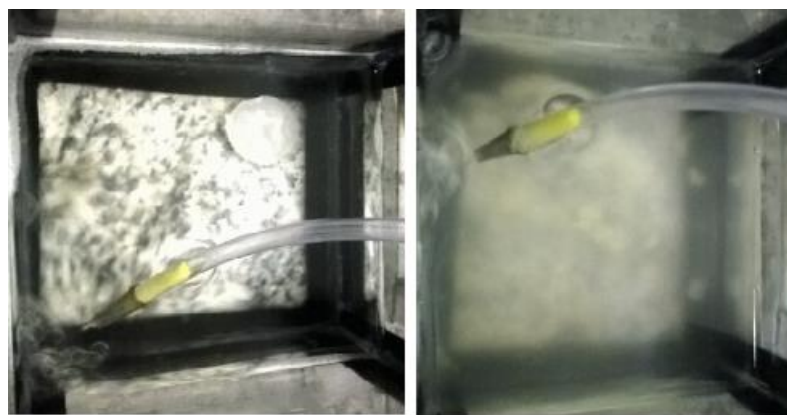
Figura 65. Aspecto inicial da água nutriente contendo PEBD/TPS (50/50%) e TPS (100%), respectivamente, do dia 29/10
