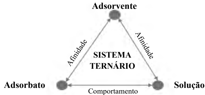
Figura 3. Relação entre os três componentes de um sistema de adsorção (Adaptado de CRINI et al. , 2019)
