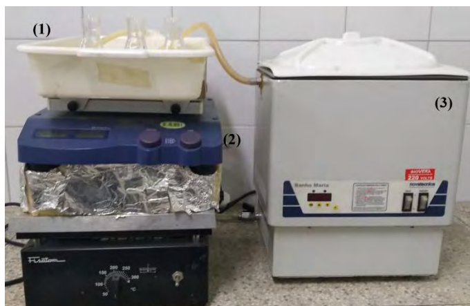
Figura 14. Aparato experimental usado nos experimentos em batelada, sendo: (1) erlenmeyers com solução de corante e adsorvente; (2) mesa agitadora e (3) banho termostático (PRÓPRIO AUTOR)
