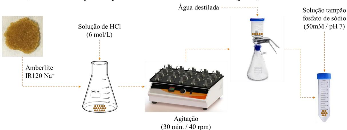
**Figura 6** – Procedimento de ativação do suporte Amberlite IR 120 Na<sup>+</sup> com uma solução de ácido clorídrico.
