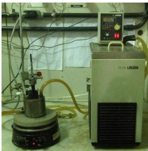
Figura 12 - Extração por SPME utilizando a unidade experimental.
