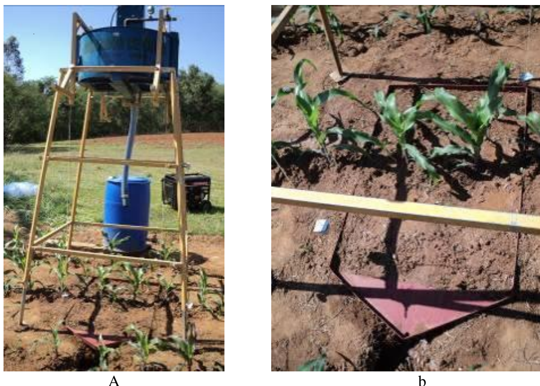
Figura 7. Vista do simulador de chuva usado no projeto (a) e parcela de coleta de erosão (b).
