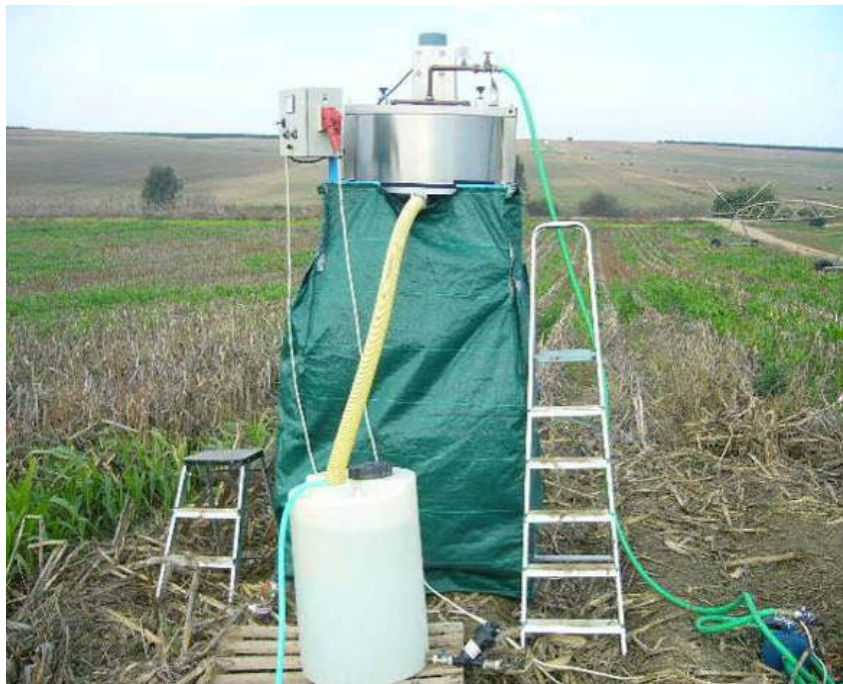
Figura 6. Esquema e foto do Simulador de chuvas portátil.
