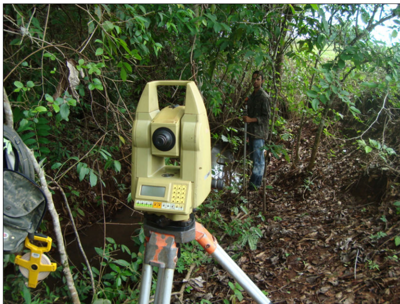
Figura 10. Estação Total utilizada no levantamento planialtimétrico.
