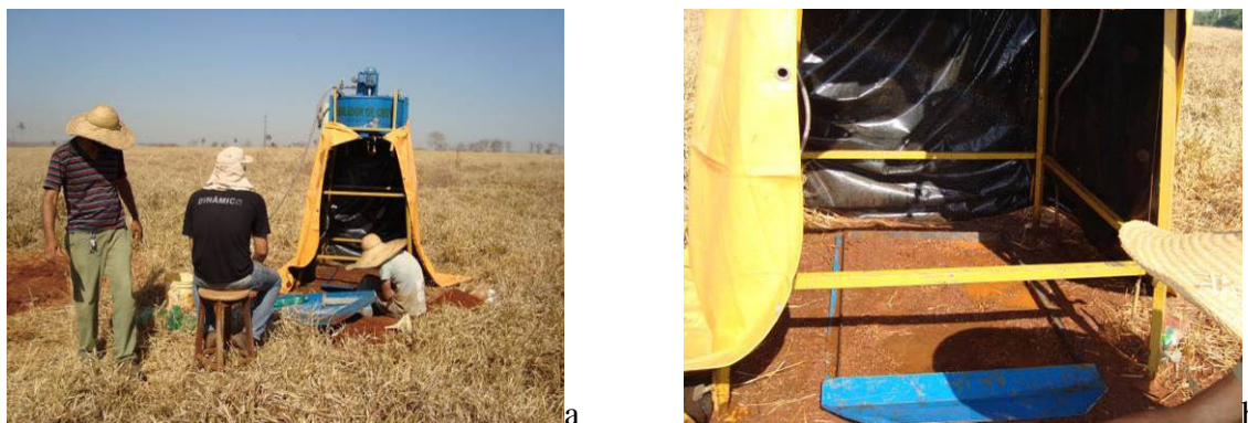
Figura 14. Simulador de chuva em operação (a) em um dos perfis – Área de pastagem (b) na microbacia.
