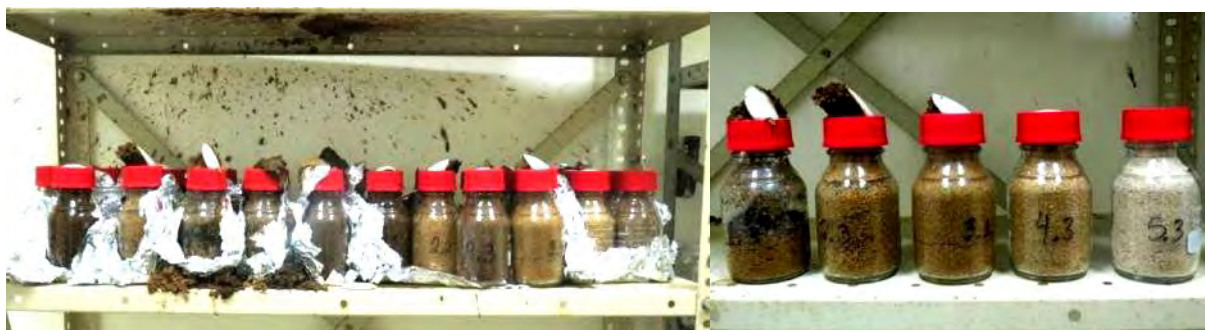
Figura 5. Ruptura da membrana dos frascos de incubação de compostos fermentados no primeiro ensaio de umidade.
