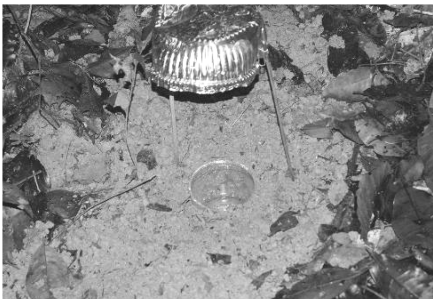
Figura 8. Armadilha “Pitfall” usada para amostragem da fauna do solo epígea em Porto Trombetas.
