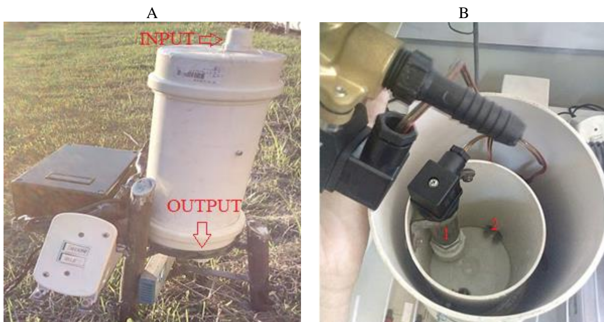
Figura 17. Protótipo do coletor automático de enxurrada com suporte de instalação de campo em vista externa (A) e vista interna mostrando o posicionamento dos sensores para mensurar o volume (1B) e a perda de solo (2B).
