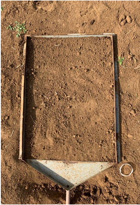
Figura 25. Estrutura da parcela coletora (A) e foto da instalação do coletor em campo junto ao simulador InfiAsper (B).
