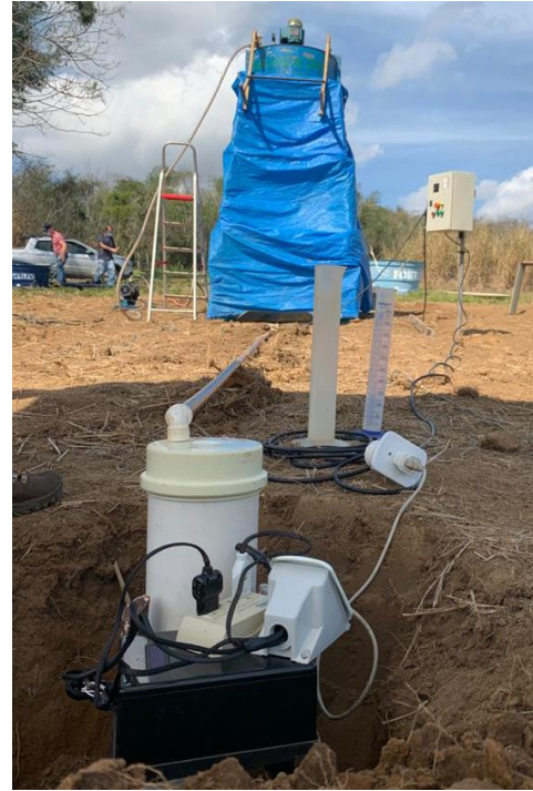
Figura 25. Estrutura da parcela coletora (A) e foto da instalação do coletor em campo junto ao simulador InfiAsper (B).
