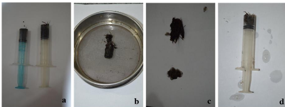
Figura 11. Algumas etapas da determinação do conteúdo de fibras: medição do volume inicial (a), tamizamento para retirada do solo (b), diferença de volume entre amostras (c) e reempacotamento para aferição do volume final (d).
