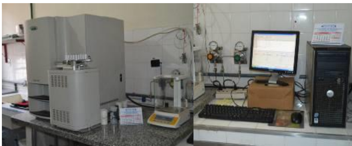
Figura 9. Analisador elementar CHN (TrueSpec Series: Carbon, Hydrogen, Nitrogen Elemental, Macro, LECO).
