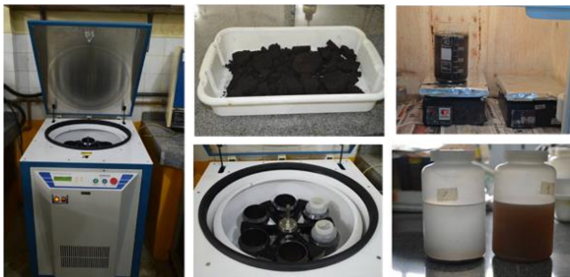
Figura 14. Etapas da extração de humina, pré tratamento para remoção dos ácidos orgânicos.
