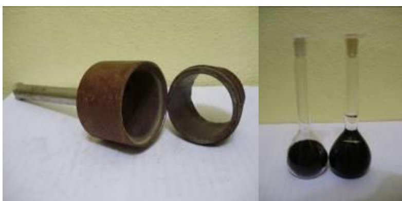
Figura 8. Anel de Kopeck para determinação de densidade do solo ( D_s ) (a esquerda) e método do balão volumétrico para densidade da partícula ( D_p ) (a direita).
