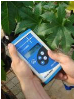
Figura 23. Leitura com SPAD para determinação do teor de clorofila a e b em folhas da mamoneira.
