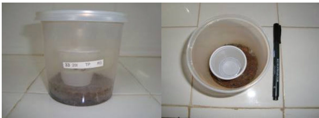
Figura 16. Unidade experimental na avaliação da taxa de mineralização da torta de mamona PDS, à esquerda vista lateral do recipiente hermeticamente fechado, e à direita vista superior do recipiente sem tampa. Ao fundo, solo + torta e sobre a mistura recipiente contendo solução de NaOH.
