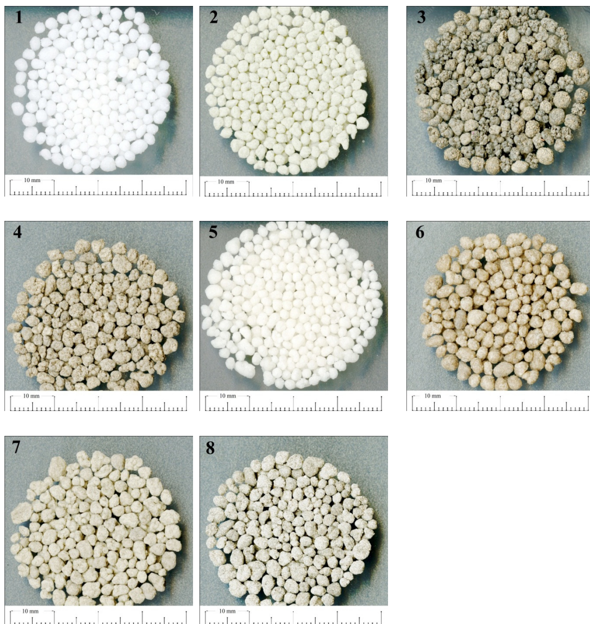
Figura 20 – Detalhe dos fertilizantes utilizados no experimento. 1 – N-Ureia; 2 – N-Ureia + Zeólita (20%); 3 – N-Ureia + Ácido Húmico (15%); 4 – N-Ureia + Ácido Húmico (5%) + Zeólita (15%); 5 – N-Ureia + Ácido Fúlvico; 6 – N-Ureia + Extrato Alcalino (pH \approx 5,5); 7 – N-Ureia + Zeólita (20%) + Extrato Alcalino (pH \approx 5,5); 8 – N-Ureia + Turfa (15%).
