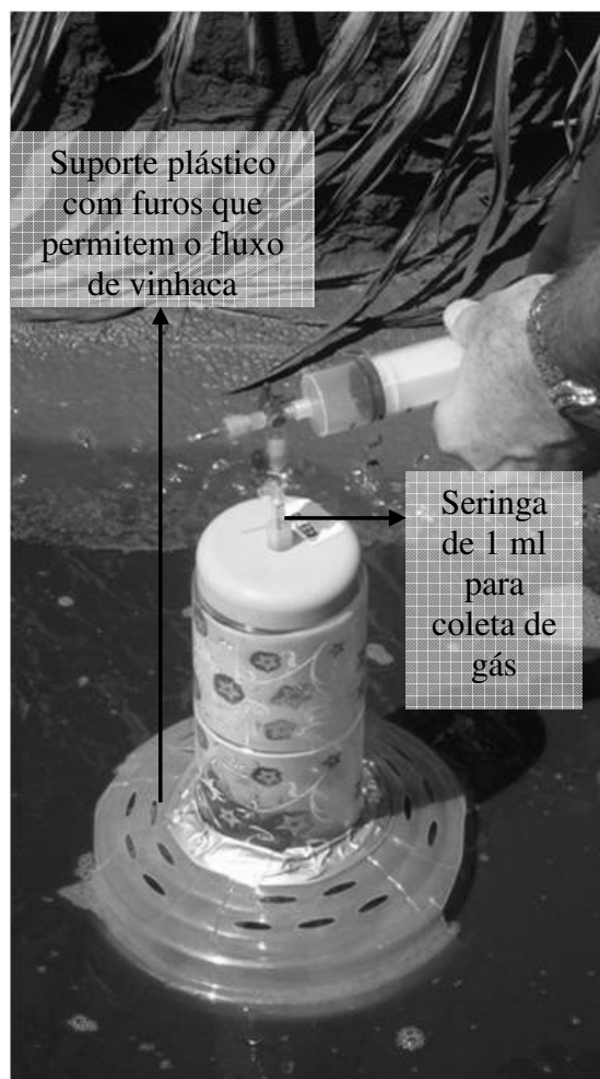
Figura 7. Câmara estática utilizada para coleta de gás em canais sem circulação de vinhaca.
