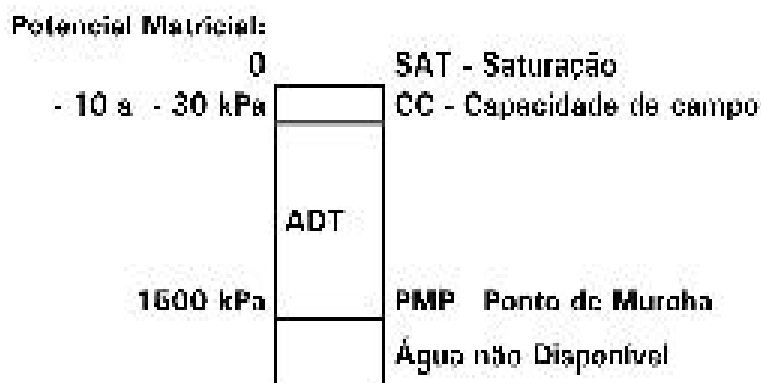
Figura 2. Capacidade de campo (CC), água disponível total (ADT) e ponto de murcha permanente (PMP). (Fonte: Couto et al., 2002)).
