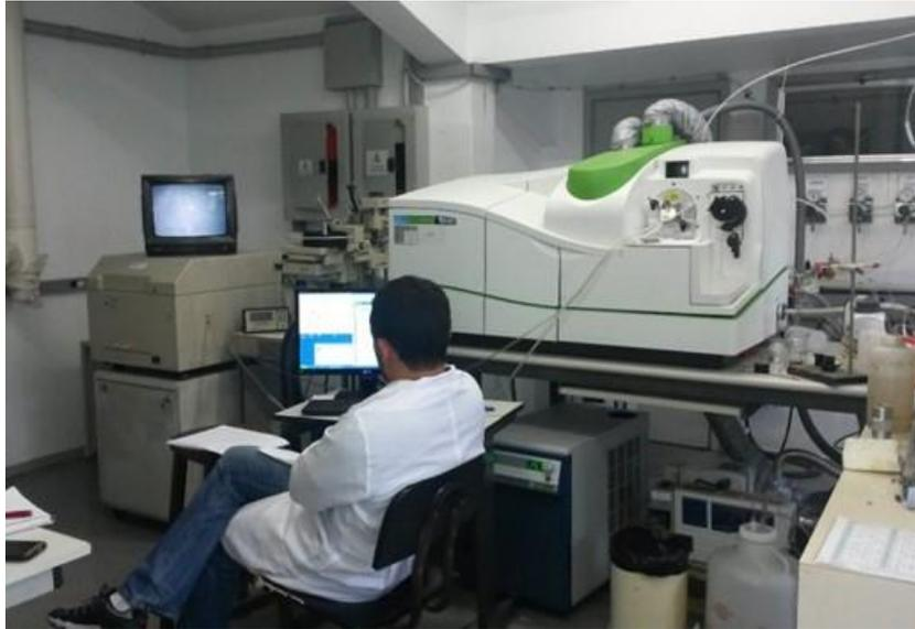
Figura 7. Equipamento de LA-ICPMS da PUC-RJ utilizado no estudo.
