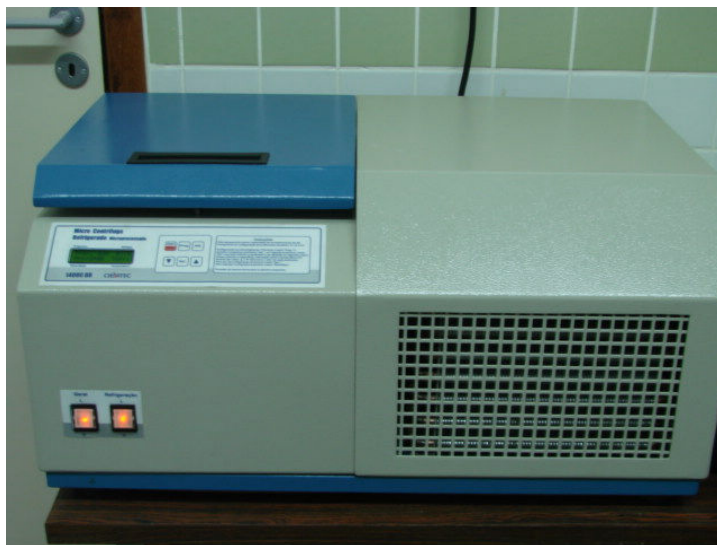
Figura 12 – Microcentrifuga refrigerada utilizada para centrifugar as amostras.
