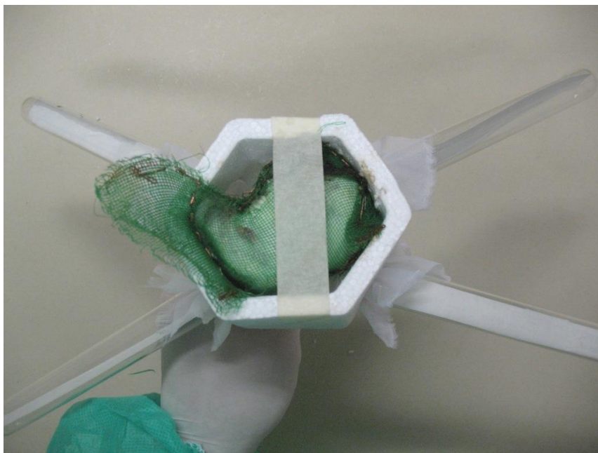
Figura 4. Aparato artificial para alimentação dos triatomíneos da espécie Rhodnius nasutus , com camundongo. Imagem: Marcio Lopes
