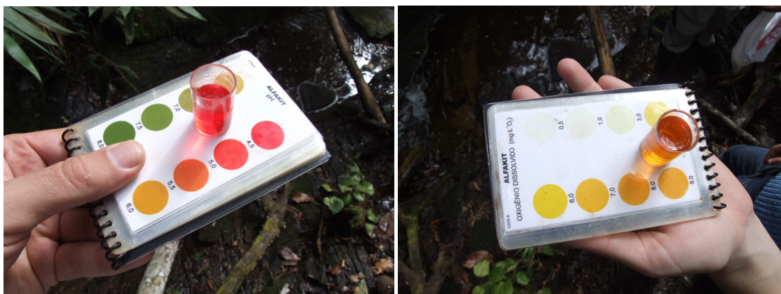
Figura 10. Método de obtenção de parâmetros físico-químicos (pH e oxigênio dissolvido) nas amostras da água dos ambientes aquáticos estudados na EBSL, Santa Teresa, Espírito Santo, Brasil, no período de abril 2008 a abril de 2010.
