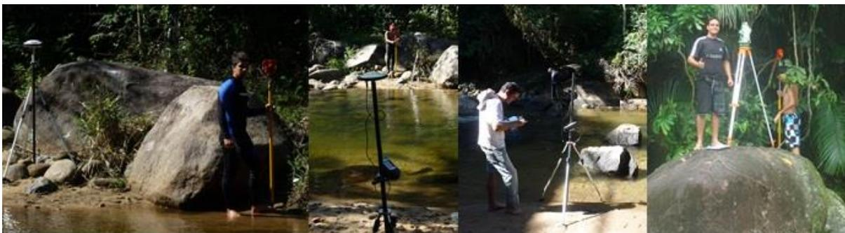
**Figura 4.** Levantamento de dados da estrutura física do canal (perfis transversais, níveis d'água, distâncias entre seções e células).
