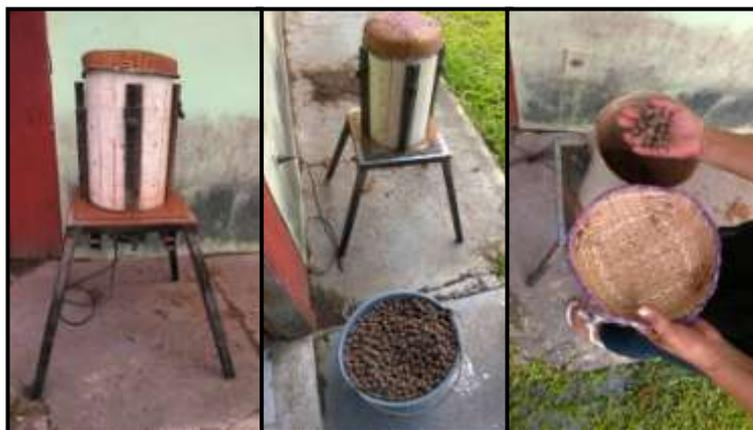
**Figura 56:** Ilustração do Lixamento mecânico no Módulo 3 - Beneficiamento de Sementes.
