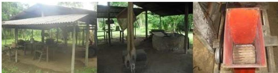
**Figura 23:** a) Casa de farinha, b) Tipiti e forno e c) Catitu.
